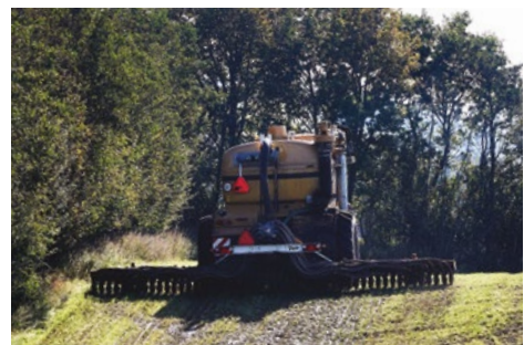
Gylle bliver nedfældet. Det vil sige, at det kommer ned i et lille hul som dækkes over igen med jord. Det sker for at forhindre, at kvælstof fordampes fra jordens overflade til luften og det er med til at dæmpe lugtgenerne fra gylleudbringning.
