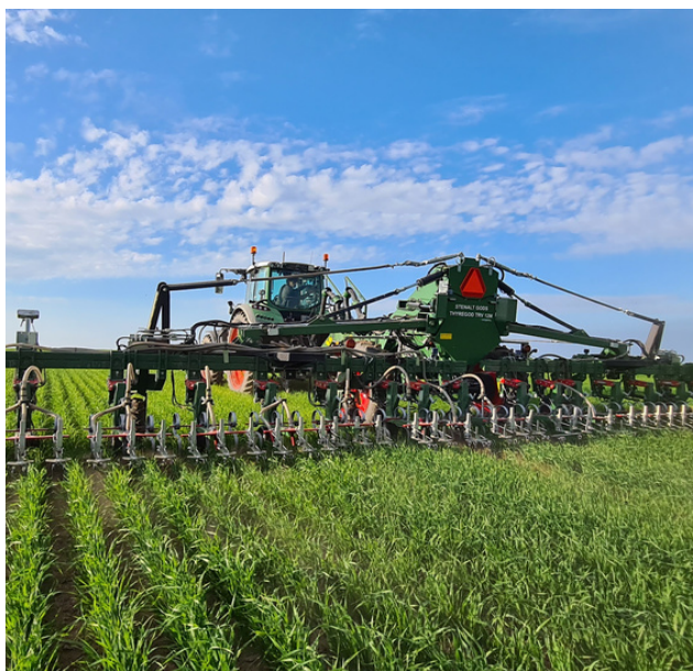
Radranseren er et effektivt redskab til at bekæmpe ukrudtsfrø. Man anvender radranseren til at fjerne det ukrudt, der spirer frem efter afgrøden, er vokset frem.
