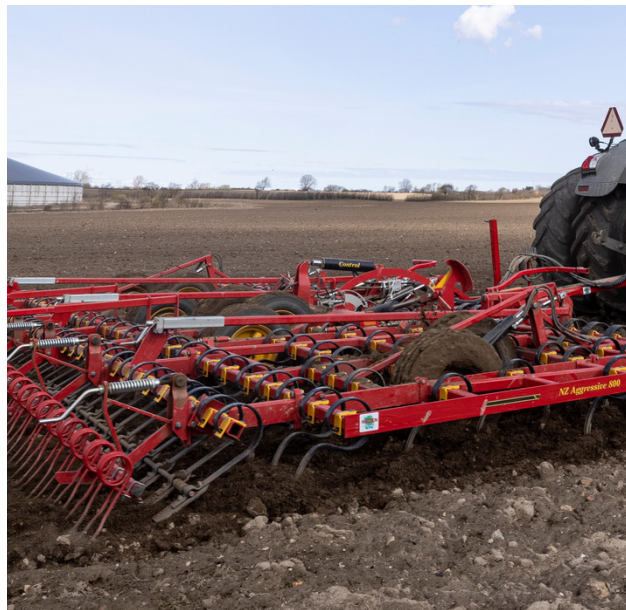
Såbedsharven bruges både under økologiske og konventionelle forhold - ofte efter pløjning. Den bearbejder pløjjorden, så marken bliver jævn og uden knolde – klar til at så i.
